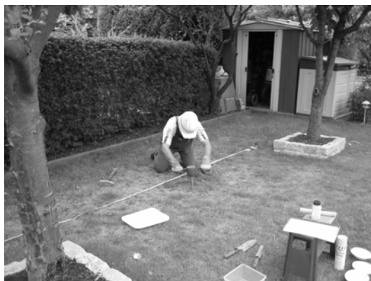
Abb. 1: Probenahme mit dem Bohrstock entsprechend Beprobungsraster
